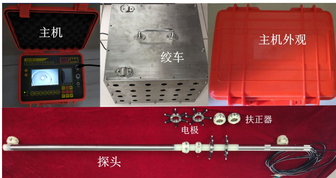
YZD18.5 矿用侧向电阻率视频成像测井仪
