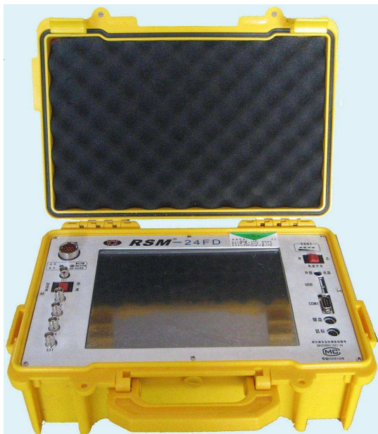
RSM-SW 剪切波波速测试仪
