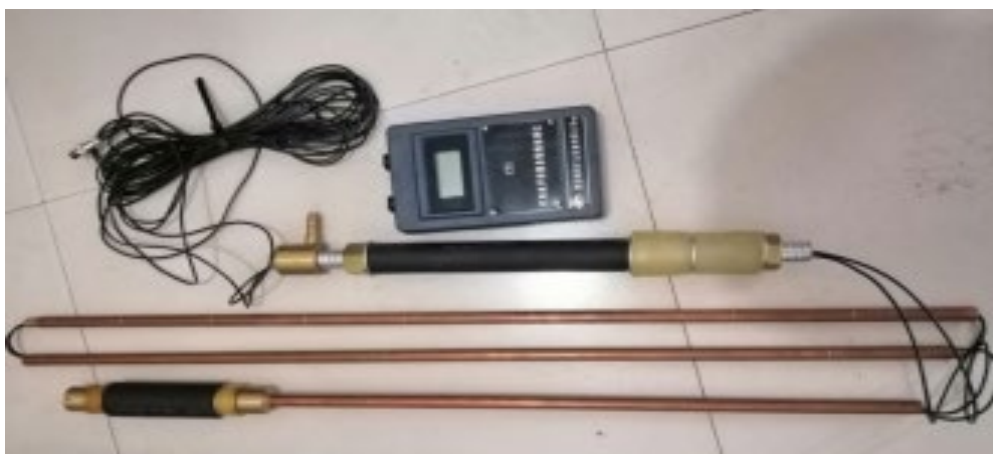
CT-2 超声波围岩裂隙探测仪
